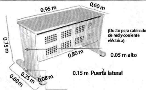
VISTA DESDE LA PARTE DE ARRIBA DE LA MESA, SE INDICA A CONTINUACIÓN DONDE SE UBICA EL TUBO RECTANGULAR (DUCTO PARA CABLEADO DE RED Y CORRIENTE ELÉCTRICA) DEBAJO DE LA MESA.
